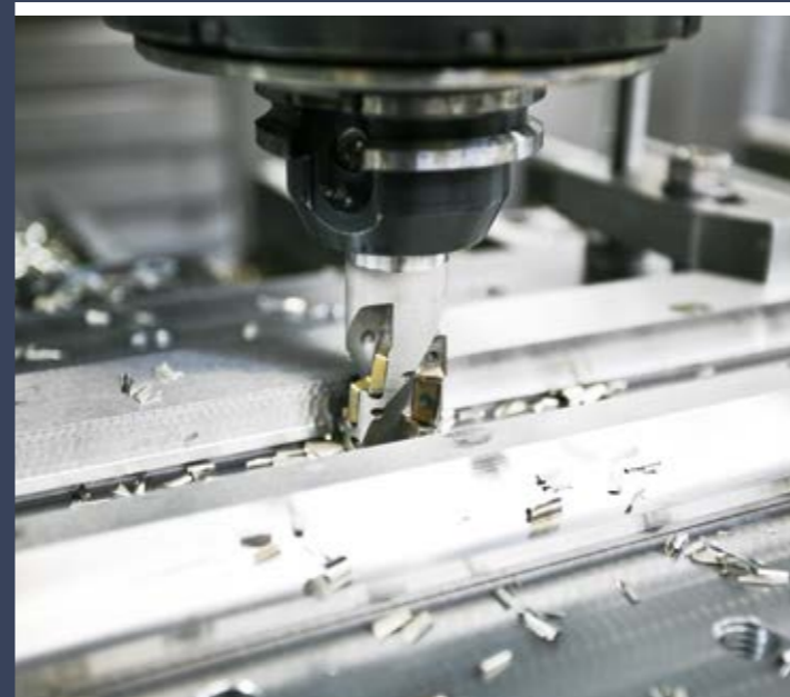
« Präzises Fräsen der gewölbten Lauffläche Precision milling of curved running surface
